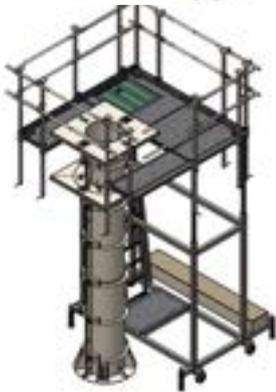
Type 1/2 coquille pour poteaux de Ø 350 / 500 accrochées sur un chariot par l'intermédiaire de chapes articulées. Le chariot est équipé d'une passerelle de bétonnage réglable en hauteur avec accès par échelle et trappe. Le décoffrage s'effectue par deux manivelles ouvrant les 1/2 coquilles, dont celles -ci sont accessibles du chariot. L'outil est auto-stable et équipé de roulettes pivotantes
