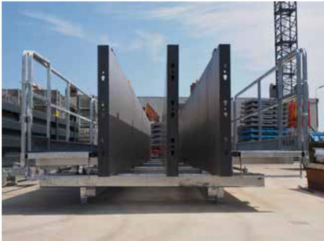
**Module de moule avec châssis type 2400 équipé de 2 passerelles**
