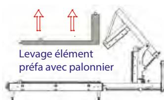
Palonnier à équilibrage de charge pour levage préfa type 2060 et 510
